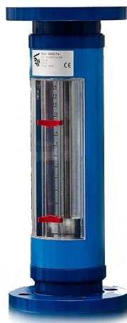
El fluido circula verticalmente de abajo hacia arriba, por el interior del tubo en forma de tronco-cónica. El flotador es impulsado por el fluido y se desplaza hasta una altura correspondiente a una sección de paso, de modo que el peso del flotador equilibra el empuje del fluido. El diámetro más grande del flotador indica el caudal instantáneo sobre la escala de la lectura grabada.
