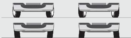
Conseqüències d'un ajustament incorrecte de la geometria dels trens de rodatge.
