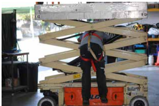
Figura 22. Atrapamiento del cuerpo o de las extremidades superiores en la estructura extensible
