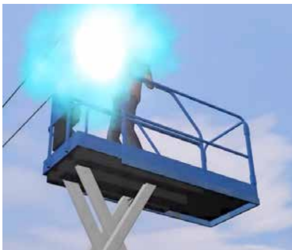
Figura 23. Contacto eléctrico directo con una línea eléctrica aérea de AT
