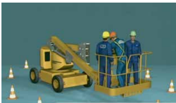
Figura 18. Plataforma de trabajo con exceso de personas
