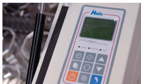
[01] Display para el control de la velocidad, temperatura y tiempo. Display to programm the operation speed, temperature and time
