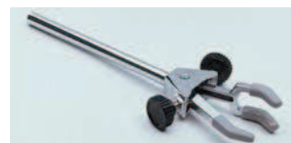
Pinza para sujetar matraces o refrigerantes. Código 7000161
