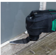
Extracción de masilla / selladores
