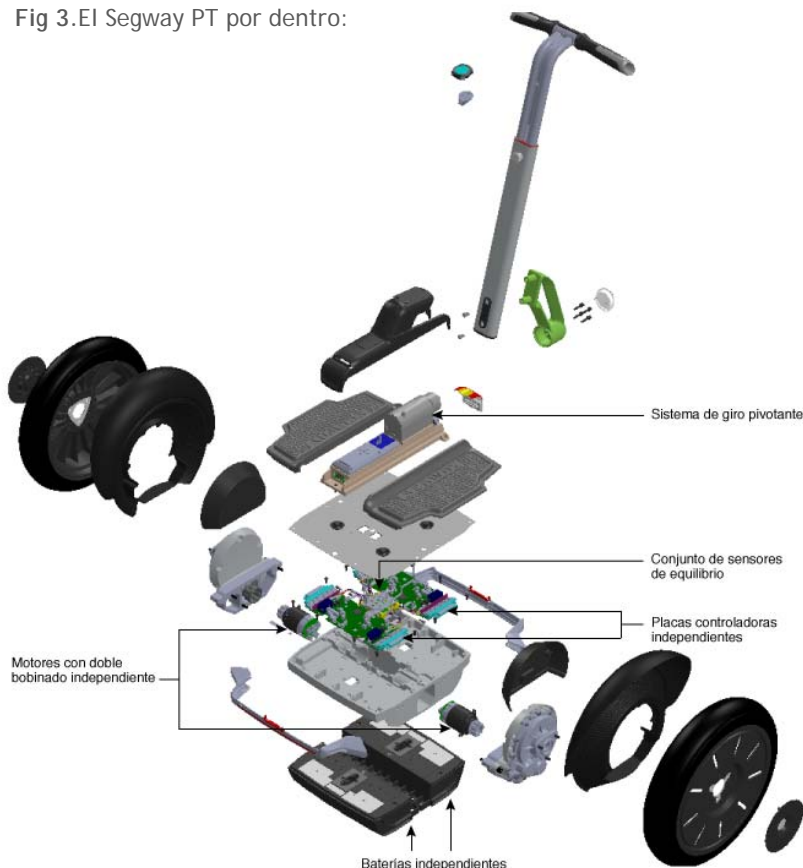
Fig 3.El Segway PT por dentro:
